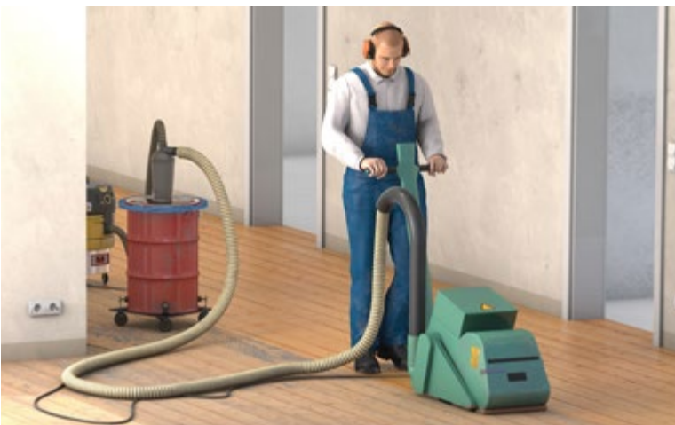
Abb. 96 Fußbodenschleifmaschine mit Absaugung durch Bau-Entstauber
