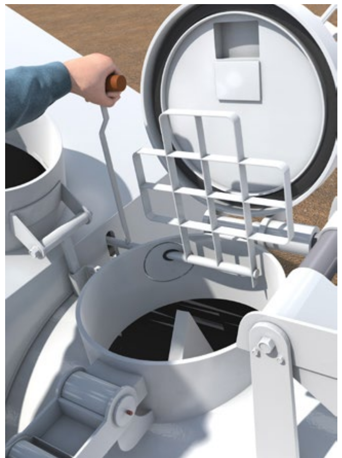
Abb. 103 Einwurf mit Schutzgitter an Estrichmaschine
