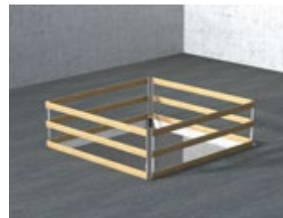
Abb. 5 Sicherung einer Öffnung durch Seitenschutz
