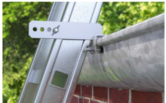
Abb. 51 Fixierung der Leiter durch Leiterhaken
