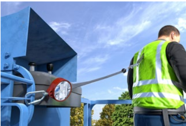
Abb. 65 Einsatz eines Höhensicherungsgerätes im Arbeitskorb
